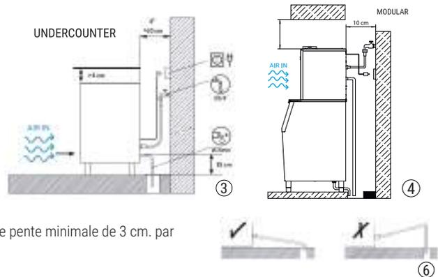
**CET APPAREIL DOIT OBLIGATOIREMENT ETRE MIS A LA TERRE afin d'éviter des électrocutions ou des dommages à l'appareil, brancher l'appareil sur une prise reliée à la terre conformément aux instructions des codes et règlements locaux. LE FABRICANT NE SERA DONC PAS RESPONSABLE DES DOMMAGES CAUSES PAR LE NON-RESPECT DE CES INSTRUCTIONS**
